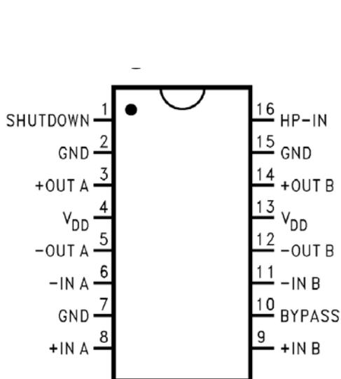
图 (1) SOP16W 和 DIP16 封装形式
